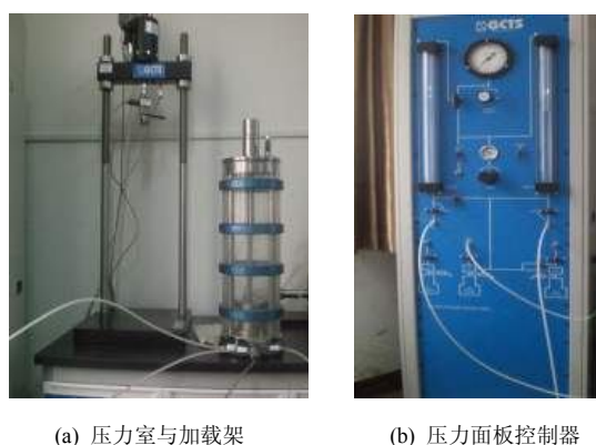
图 2 GCTS 三轴测试系统 Fig.2 GCTS triaxial testing system
